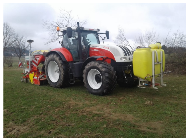
Bild 6: „Engerling-Kombination Neudorfer“; Artis Pro wird beim 2. Bearbeitungsgang vor der Kreiselegge ausgebracht und damit sofort eingearbeitet; Thomas Neudorfer.
