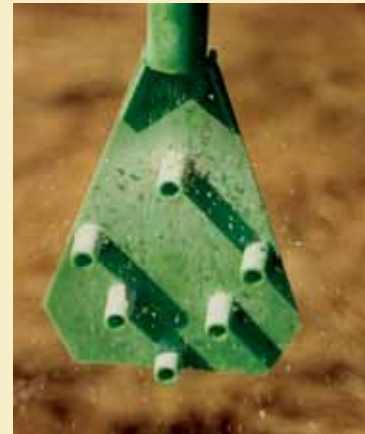
Der Streuapplikator verteilt das Granulat in einer Streubreite von 0,5 - 0,6 m.
